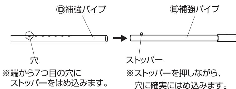
2.連結した④据強パイプと⑤据強パイプの両端に
