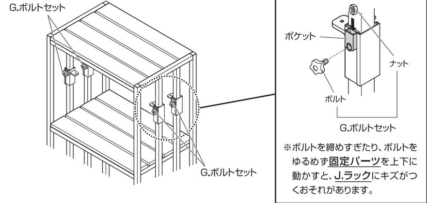
※ ボルトを締めすぎたり、ボルトをゆるめず固定パーツを上下に動かすと、J.ラックにキズがつくおそれがあります。
