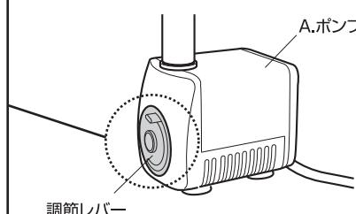
※ポンプを空転(水から出して回す)させると、インペラーに泡がつき、水をくみ上げられなくなります。一度コンセントから電源プラグを抜いて、ポンプを止め、もう一度コンセントに電源プラグを差し、「エア抜き」をしてください。
