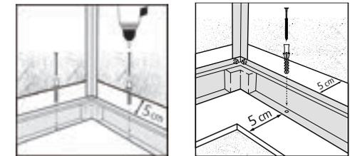
適切なネジとプラグまたはアンカー（付属していません）を使用して製品を基礎に固定してください。
