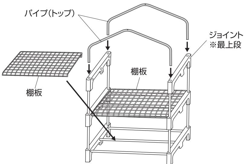
3.パイプ(トップ)の上部穴に補強棒を取り付けます。
