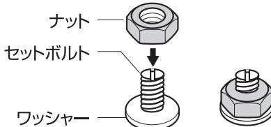
※締め付け後、セットボルトがナットから少し出る
