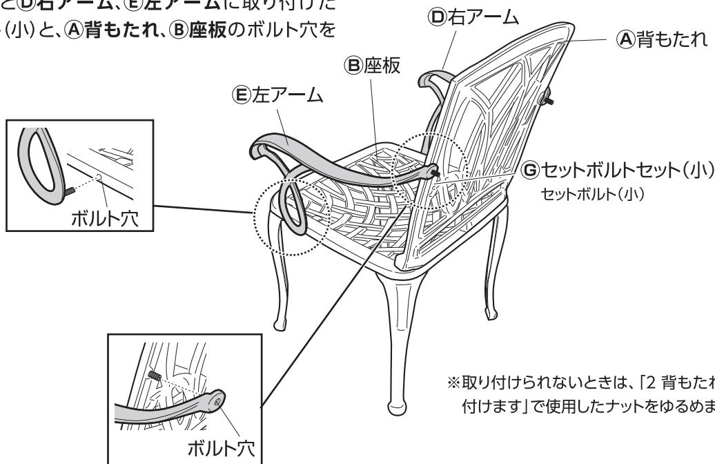
※取り付けられないときは、「2 背もたれを取り付けます」で使用したナットをゆるめます。
