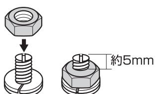
※締め付け後、セットボルトが5mm程度、ナットから出るぐらいが目安
