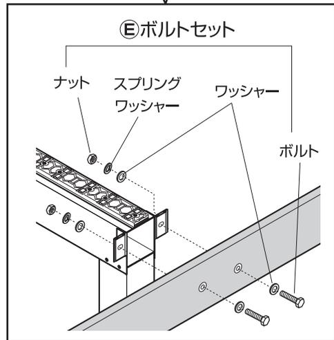
◎ボルトセット4セットは「脚付きフレームおよびボルトセットについて」(P.3)で取り外したものを使用してください。
