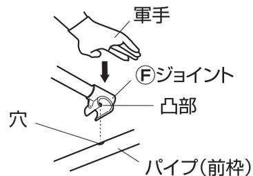
⑥ジョイントの凸部をパイプ(前枠)の穴へしっかり差し込みます。
