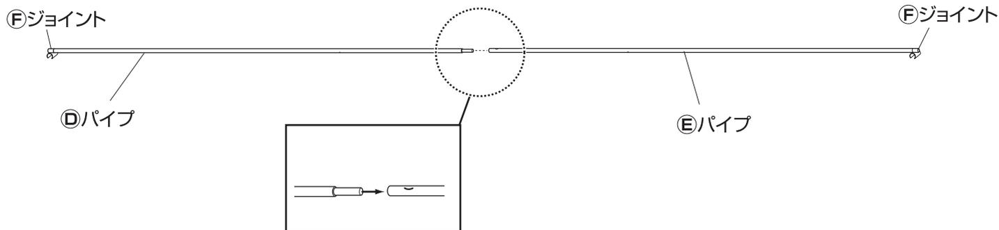
3. 組み立てたパイプを⑥シェードのポケットに差し込みます。
