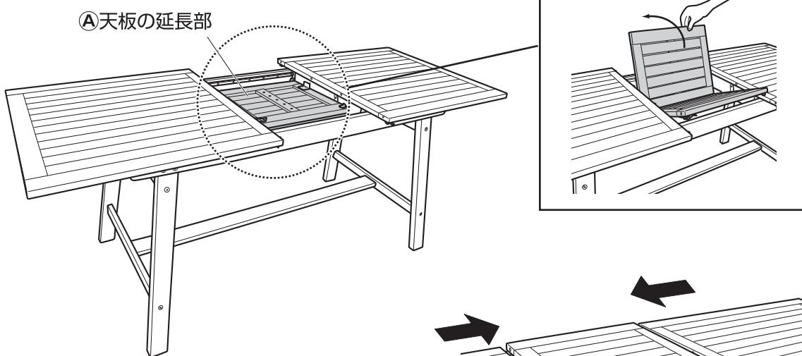
2. 天板を閉じます。ピンをピン穴に差し込み、天板を固定します。
