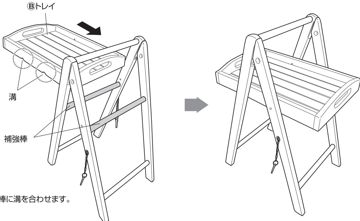
2. ③ストッパーピンをピン穴に差し込み、②トレイを固定します。
