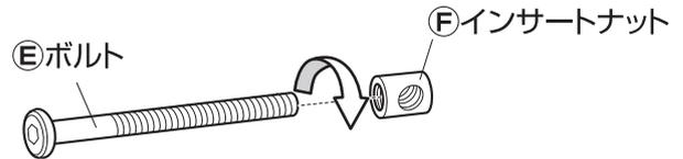
2. ①座板または②背もたれの穴に⑥インサートナット(⑤ボルト取り付け済)を挿し込みます。③④脚の座グリ穴から⑤ボルトを挿し込み、仮留めします。(計2カ所)
