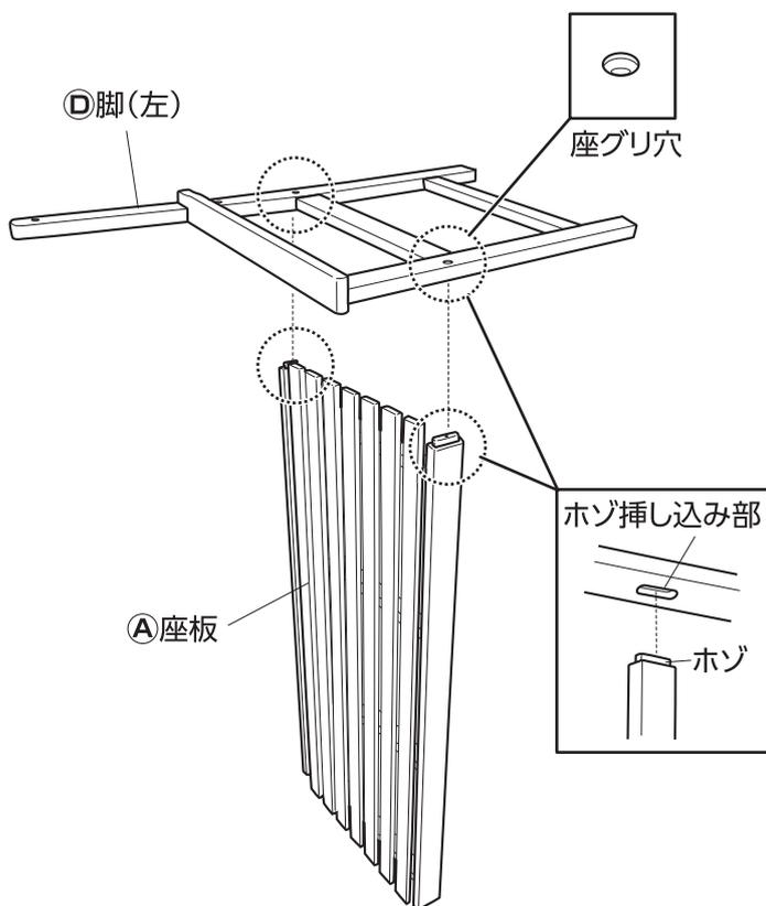
2. **①座板**の穴に**⑥インサートナット** (**⑤ボルト**取り付け済)を挿し込みます。**④脚(左)**の座グリ穴から**⑤ボルト**を挿し込み、仮留めします。(計2カ所)
