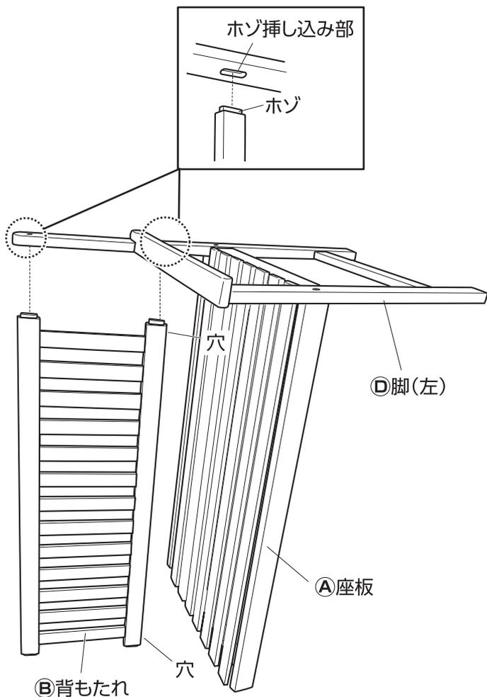
3. ③背もたれの穴に④インサートナット(④ボルト取り付け済)を挿し込みます。②脚(左)の座グリ穴から④ボルトを挿し込み、仮留めします。(計2カ所)
