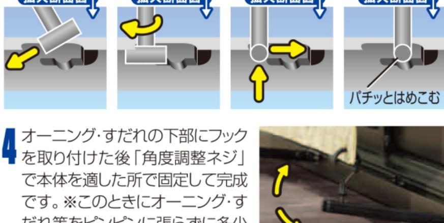
4 オーニング・すだれの下部にフックを取り付けた後「角度調整ネジ」で本体を適した所で固定して完成です。※このときにオーニング・すだれ等をピンピンに張らずに多少の余裕を持って取り付けて下さい。
