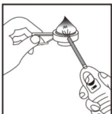
①図のように本体を水平にし、ライターなどで接着剤が透明なアメ状（気泡が出てくるくらい）になるまで約1分間炎を回すようにしながら全体をむらなく溶かしてください。
