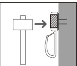
③取り付けた後すぐにピンを直接ハンマーで本体と平面になるまでゆっくりと打ち込んでください。打ち込む際、本体には余分な衝撃は与えないでください。2本の針の頭部がプラスチックの表面に見える場合があります。
