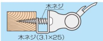
締付ネジをはずし市販の木ネジで直接取り付けてください。
