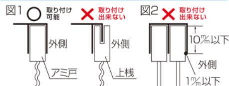
(図2の様に枠の取付部10ミリ以下、枠と戸の隙間1ミリ以下の場合は取り付け出来ません)
