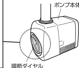
※商品の特性上、ホースを接続せずに使用すると、正しく動作(吐水)しません。必ず、ホース(長さ10cm以上)を接続してください。
