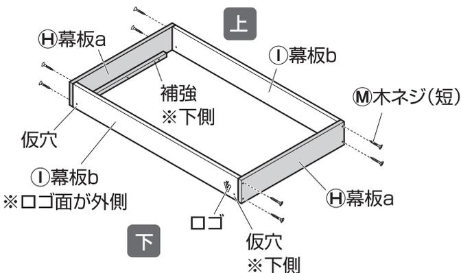
2. 幕板を本体にかぶせ、①幕板b側から②木ネジ(短)で仮留めします。(計4カ所)
