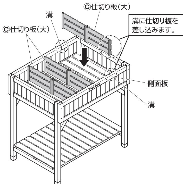
2. ⑪仕切り板(小)を側面板と⑩仕切り板(大)の溝に差し込みます。
