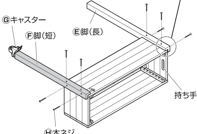
※⑦脚(短)は持ち手側と反対の面に必ず取り付けてください。
