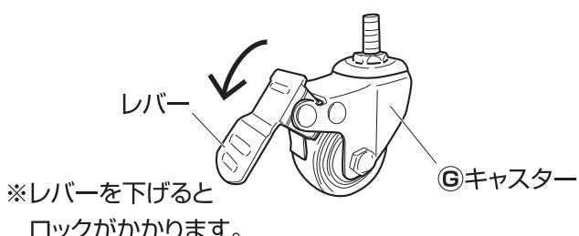
裏面にあるロック板と回転軸の凸凹が合わさって止まる仕様です。レバーを下げる際、凸凹が合うように、タイヤ軸を回転させて、ロックしてください。
